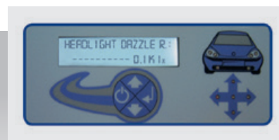
Icona a croce: indica la posizione attuale del faro Icona auto: indica quale è il faro in test. Cross Icon: showing actual position of the beam Car Icon: showing which is the beam under control. Kreuz-Symbol: aktuelle Position der Strahl PKW- Symbol: Scheinwerfer unter Prüfung. Ícono a cruz: muestra la posición real del haz ícono del coche: muestra cual es el haz en prueba.
