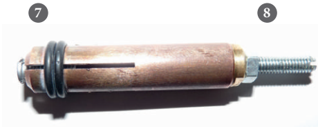
Boquilla en cobre a 4 grietas para soldar las clavijas M4 (diámetro Ø 4 mm)
