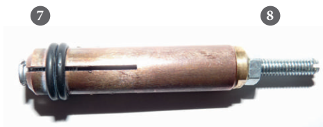
Медный наконечник с 4 прорезами для приваривания шпилек М4 (диаметр Ø 4 мм)
