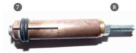
Puntale in rame con 4 fessure per saldare perni in alluminio M4 (diametro \varnothing 4 mm)
