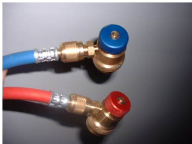
мал. 9 а– шланги високого та низького тиску з роз'ємами для підключення до системи кондиціонування.
