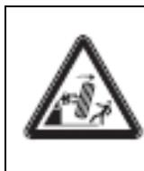
Снятие покрышек с колесных дисков может вызвать падение шины. всегда проверяйте, чтобы никто не находился в рабочей области во избежании несчастных случаев.
