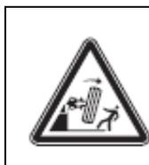
Убедитесь, что колесо надежно закреплено, чтобы избежать его падения во время работы. Для тяжелых и/или очень больших колес используйте подходящее подъемное устройство.
