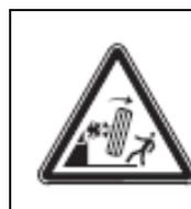
Снятие покрышек с колесных дисков может вызвать падение шины. всегда проверяйте, чтобы никто не находился в рабочей области во избежании несчастных случаев.
