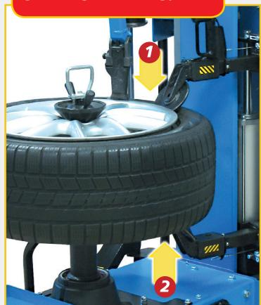
Отжим покрышки производится при помощи двух синхронно работающих роликов. Быстрый демонтаж с обеих сторон колеса.
