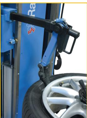
Приподнимая борт, головка оттягивает его, таким образом, снижая нагрузку.
