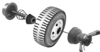
Когда внешняя сторона диска имеет очевидную деформацию, применяется этот способ установки с конусом позади, что гарантирует точную посадку колеса на вал. Такой способ также удобен для некоторых стальных дисков и особенно толстых алюминиевых дисков
