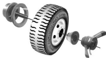
Данный способ установки применяется к дискам, диаметр центрального отверстия которых менее  $\Phi 135$
