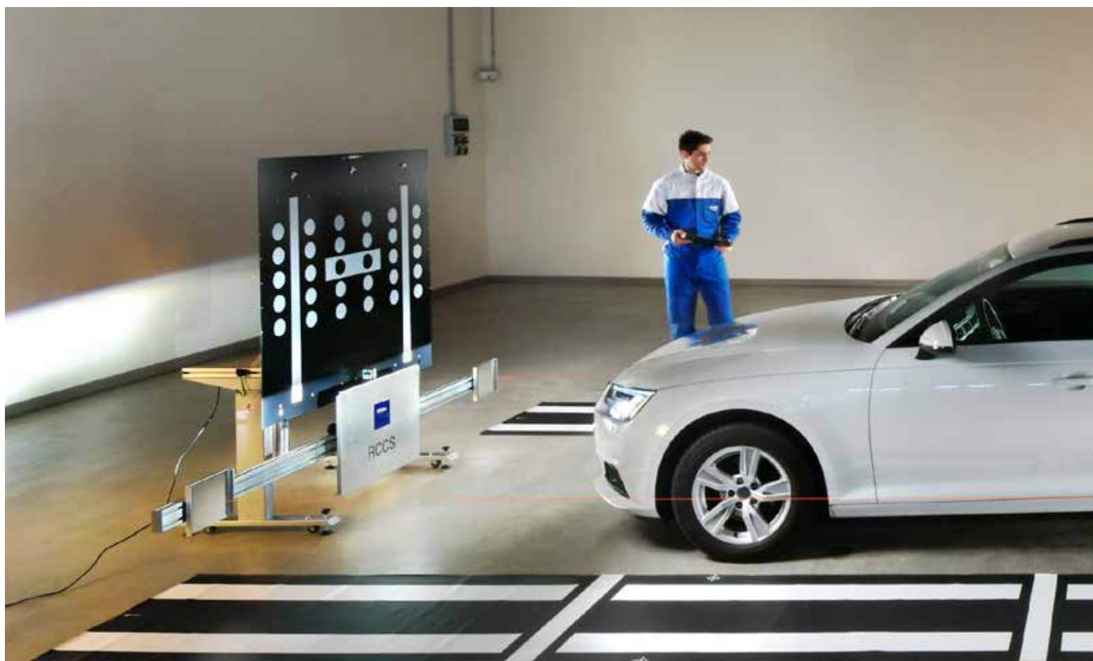
Система RCCS, используемая вместе с боковыми напольными панелями для видеокамер на 360°, мишень для калибровки задних видеокамер, устройство для радаров blind spot.
