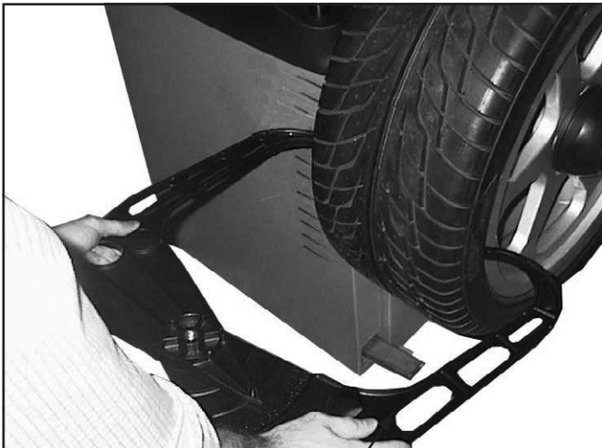
определение величины ширины диска вручную кронциркулем
