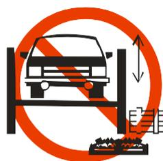
12. Не раскачивайте автомобиль на подъемнике!
